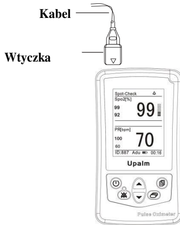
Rysunek 4.2: Odłączanie lub podłączanie czujnika
